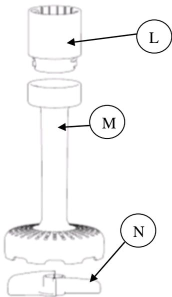
L. Перехідник насадки для приготування картопляного пюре
